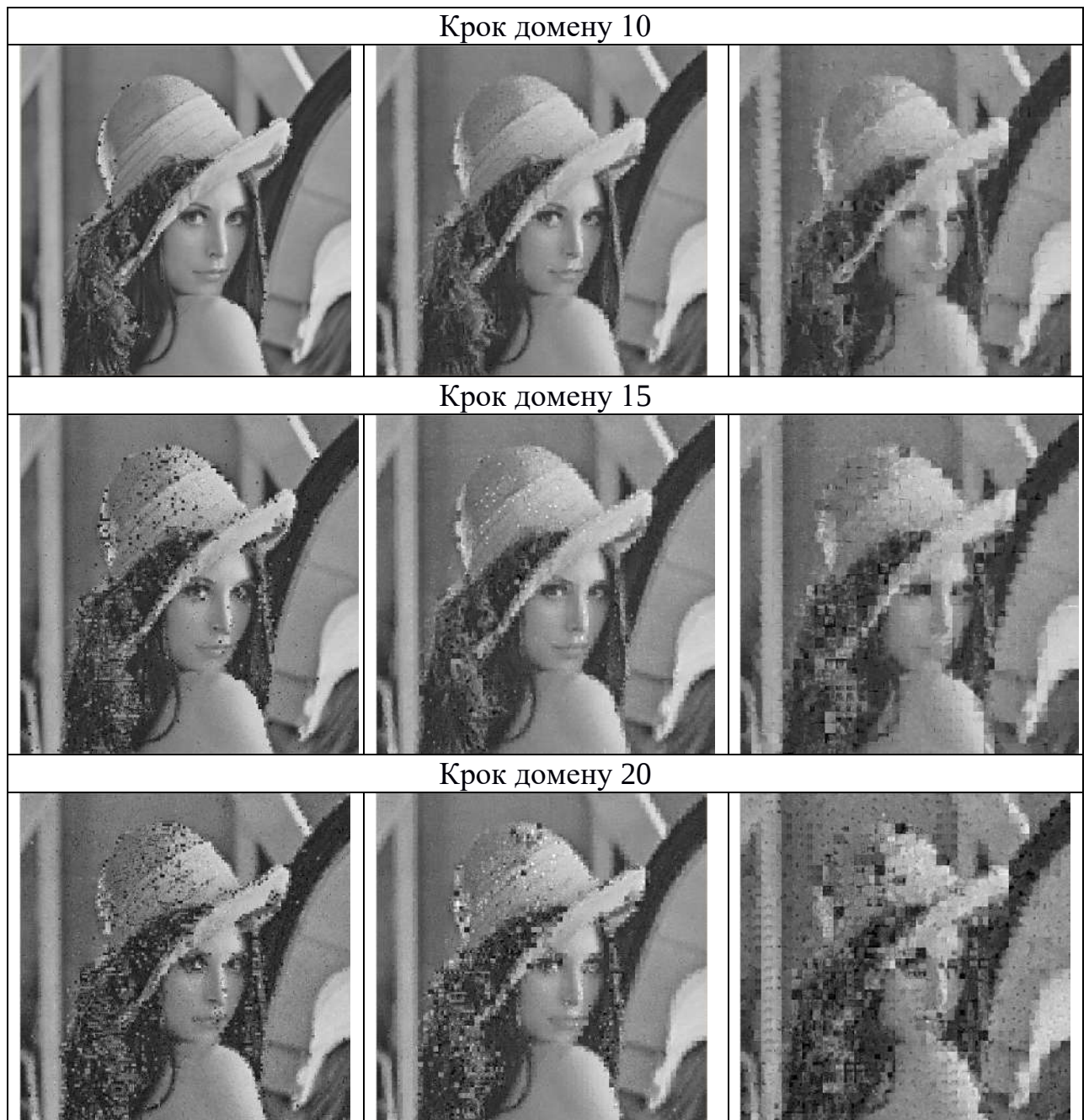
Рис. 4.14 – Стиснення півтонового зображення з однаковим кроком домену, але з різними розмірами рангових блоків.
