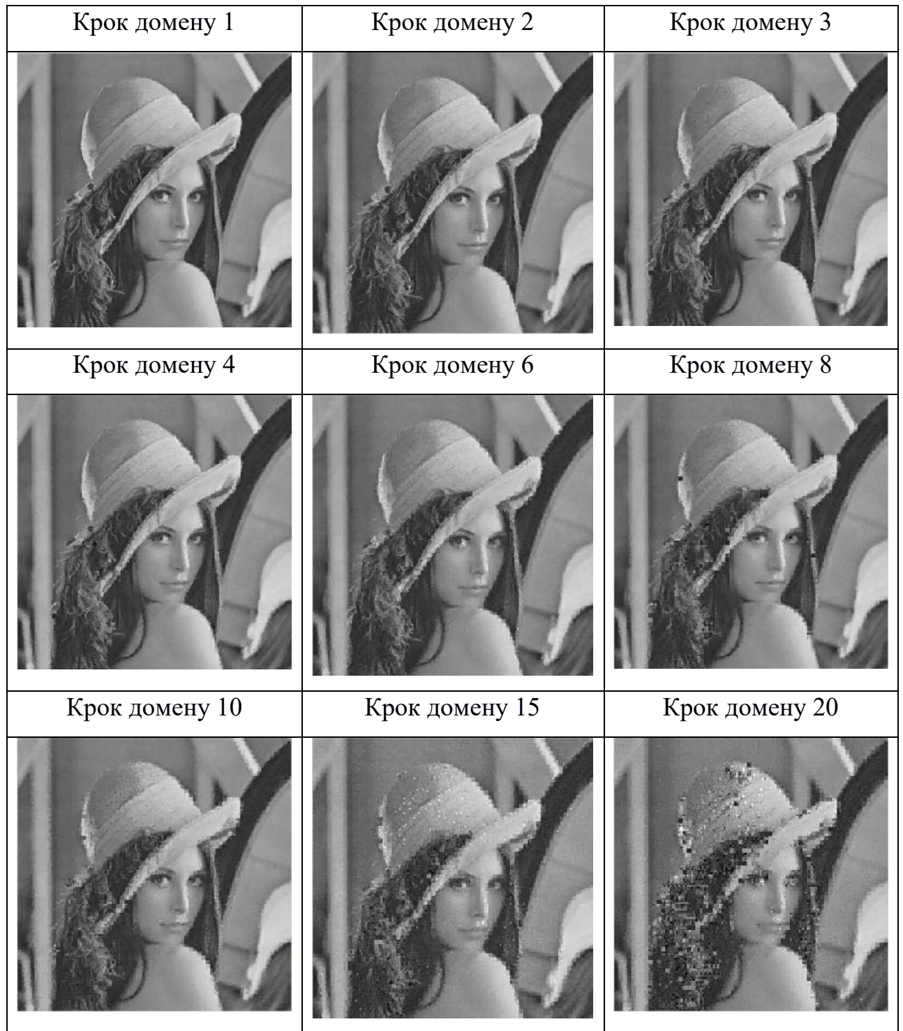
Рис. 4.12 – Стиснення півтонового зображення з розміром рангового блоку 8x8
