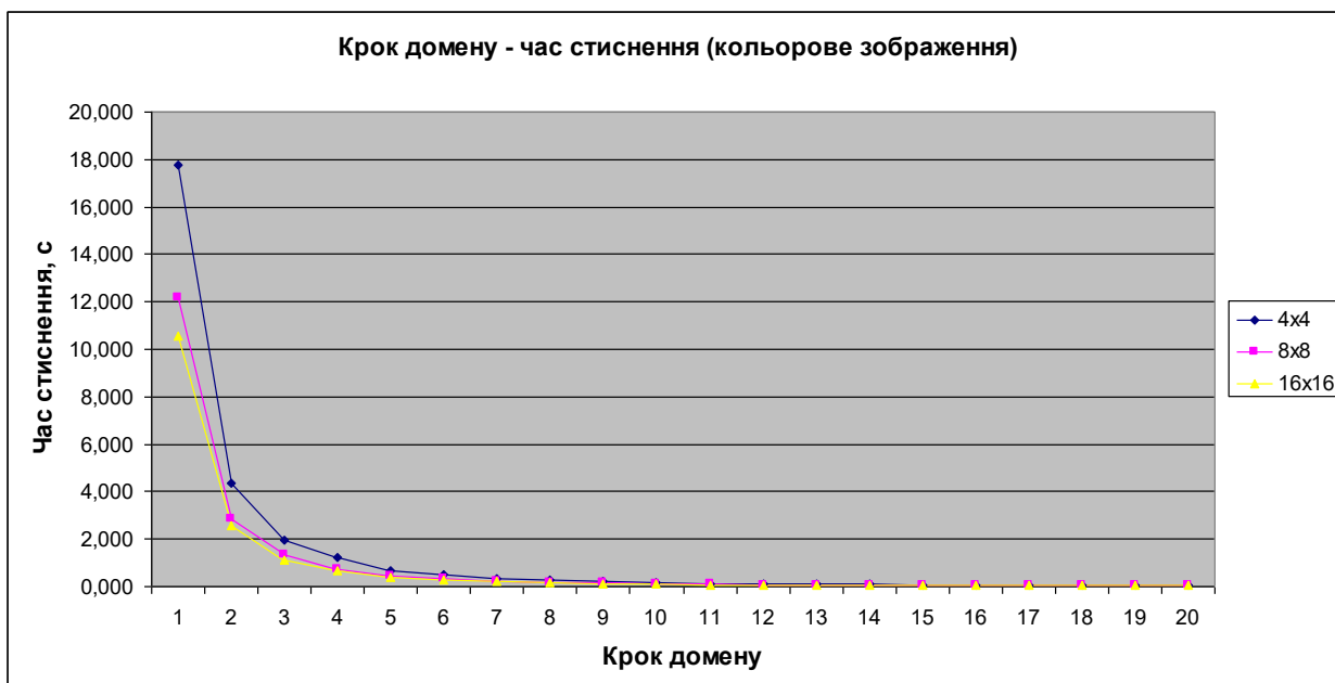
Рис. 4.20 – Залежність часу стиснення від кроку домену для різних розмірів рангового блоку кольорового зображення (4x4, 8x8, 16x16)
