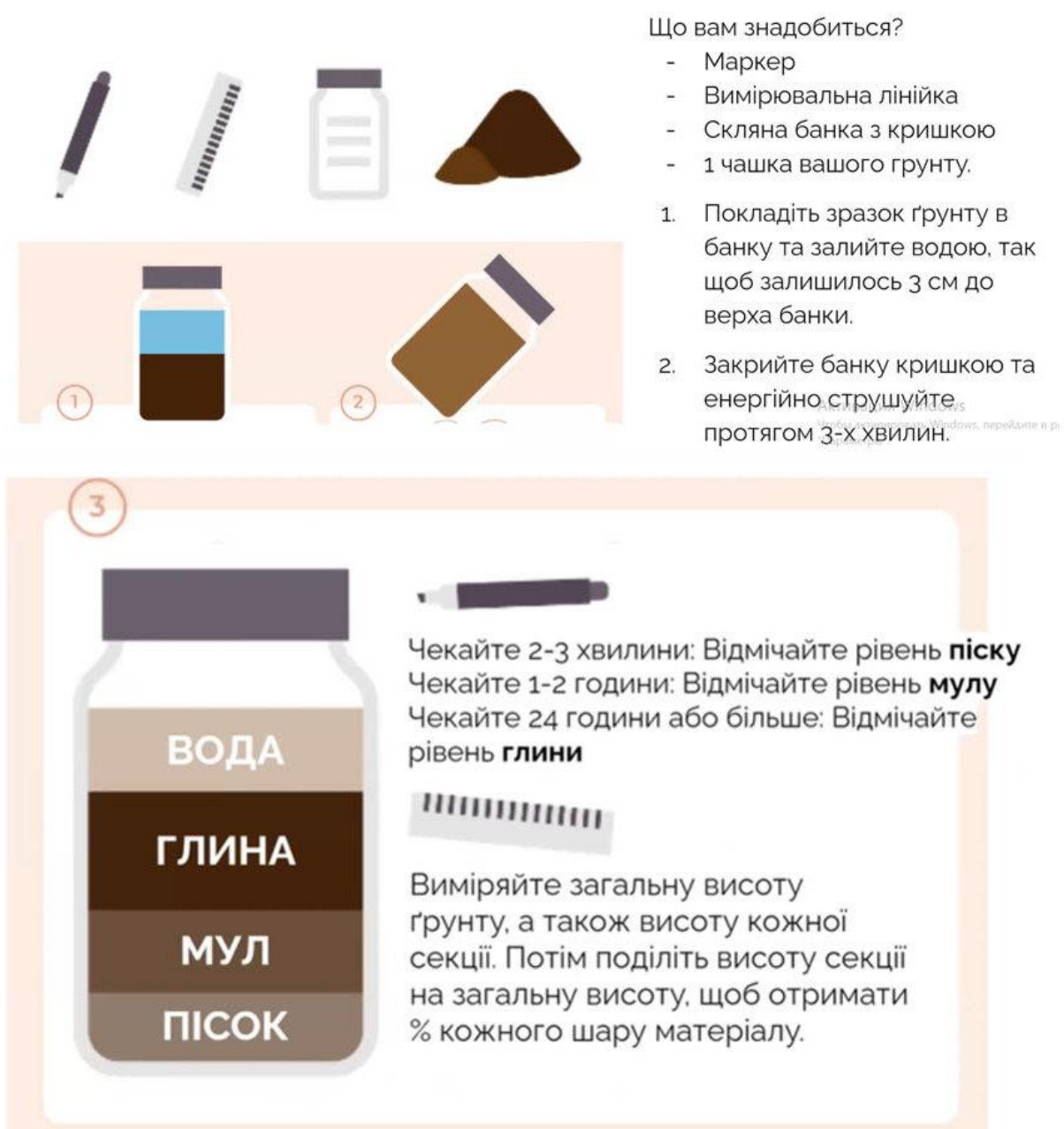
Рис.А.1 Схема «банкового» аналізу ґрунту, рис. із курсу платформи «Закохані у сад»
